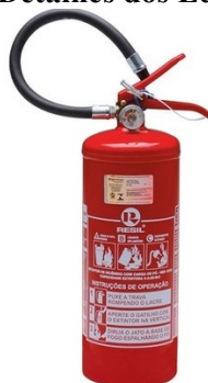
EXTINTOR PORTÁTIL DE PÓ QUÍMICO SECO (PQS), CAPACIDADE DE 6kg. CLASSE EXTINTORA: ABC.
